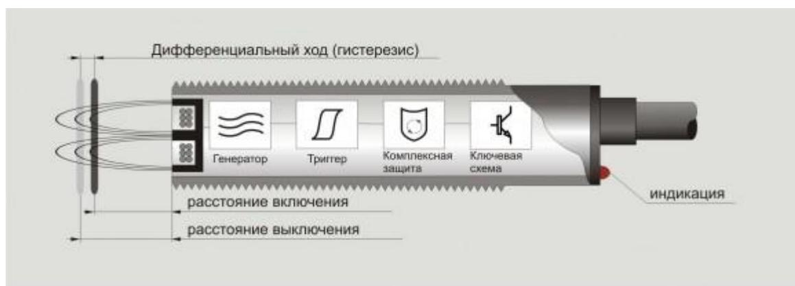
Рисунок 10 – Схема функциональная индуктивного датчика с комплексной защитой
