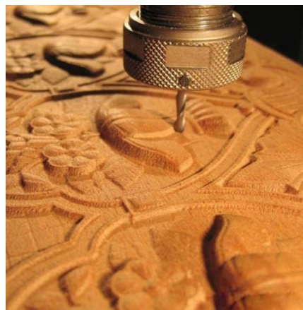
Рис.2.6.5 Формирование рельефа на фрезерном станке с ЧПУ
