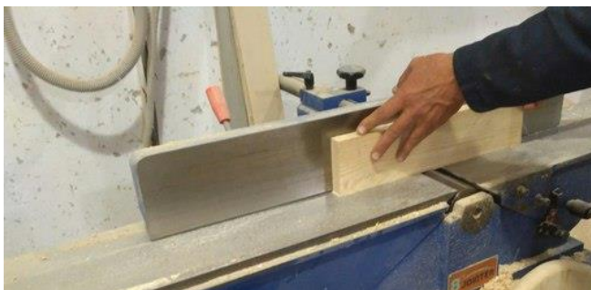
Рис. 2.6.6 Процесс обработки на фуговальном станке
