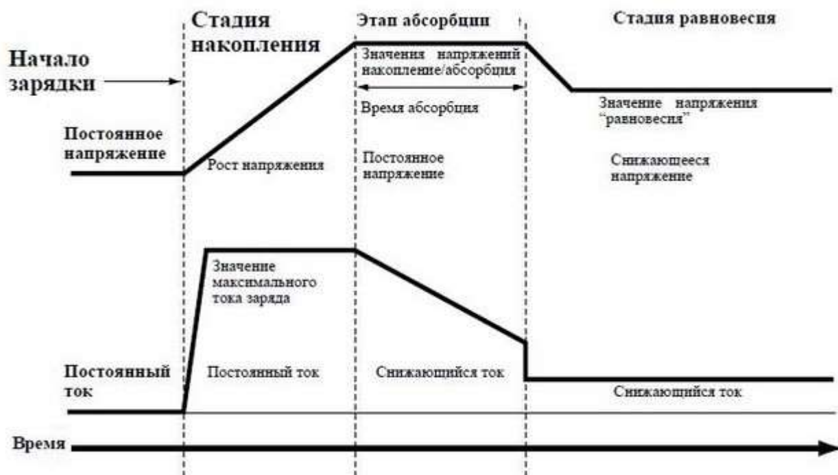
Рисунок 2 – Заряд аккумулятора по алгоритму ШИМ
