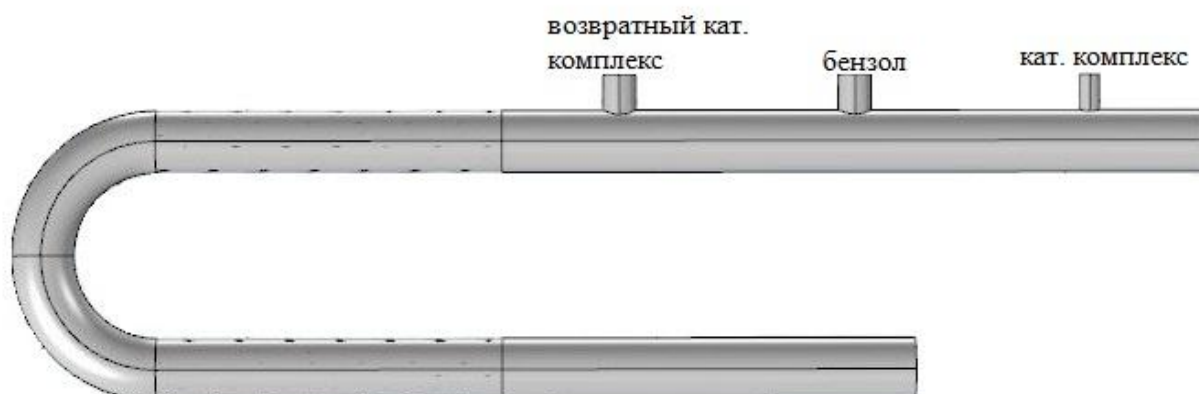
Рисунок 7 – Схема расположения патрубков
