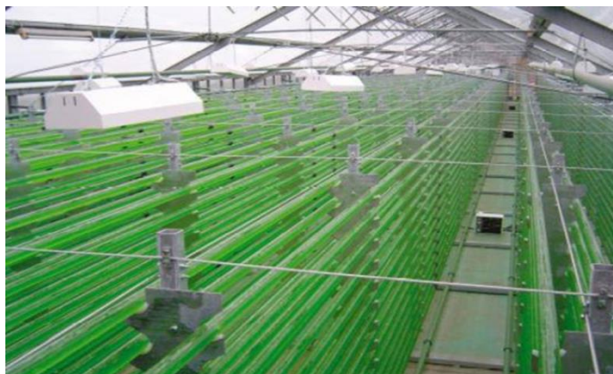
Рисунок 1.2.7 – Фотобиореактор закрытого типа
