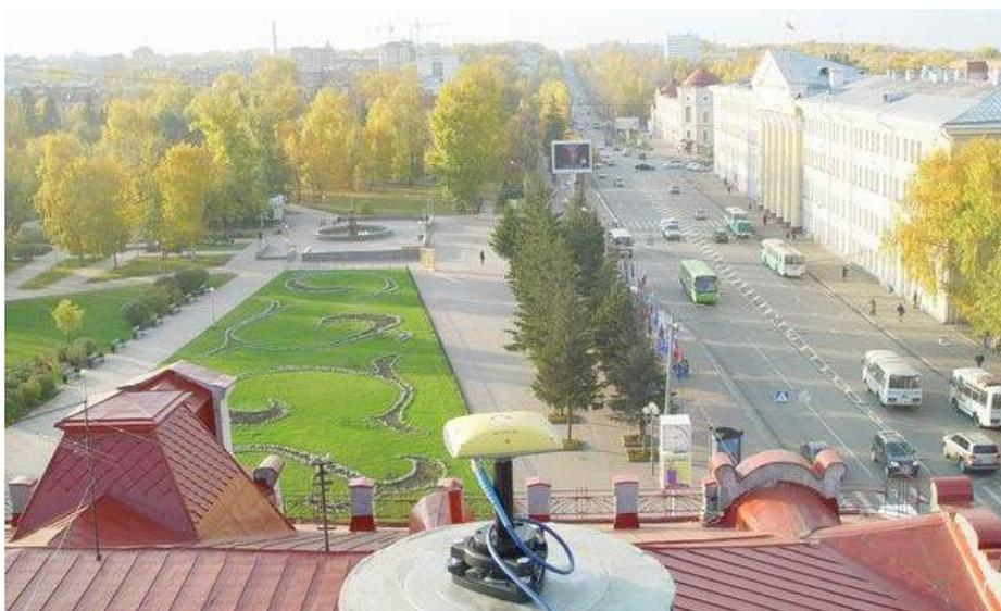
Рисунок 10 - Исходный Пункт спутниковой геодезической сети на здании
