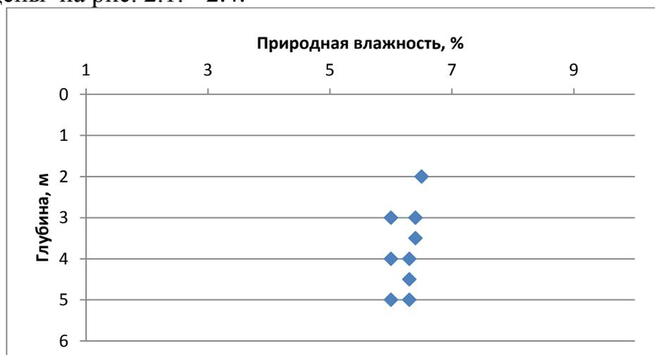
Рис.2.1. График изменчивости природной влажности валунного грунта ( $dpQ_{III-IV}, cQ_{III-IV}$ ) по глубине
