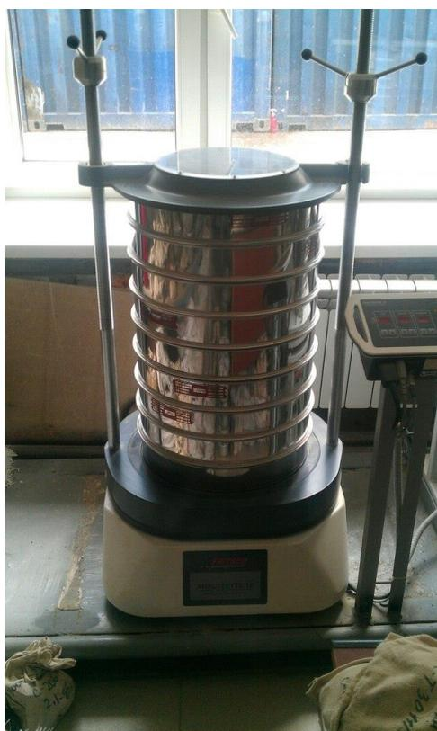
Рис.3.3. Определение гранулометрического состава(сита и анализатор ситовой)
