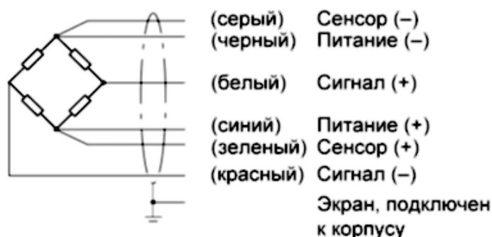
Рисунок 3 – Шестипроводная мостовая схема датчика С16А
