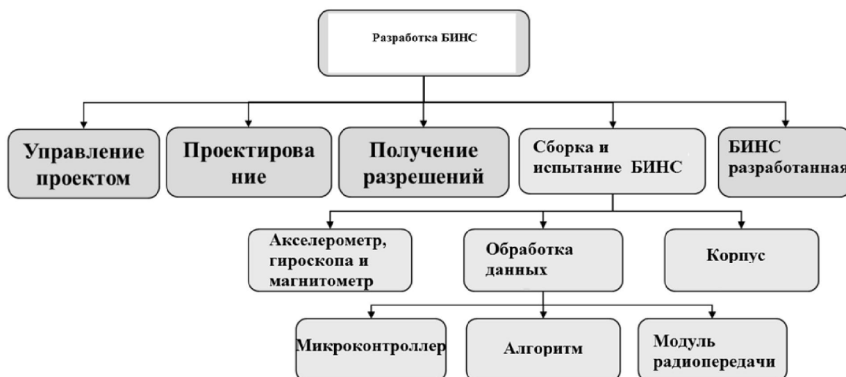
Рисунок 3.1 - Иерархическая структура работ по проекту БИНС
