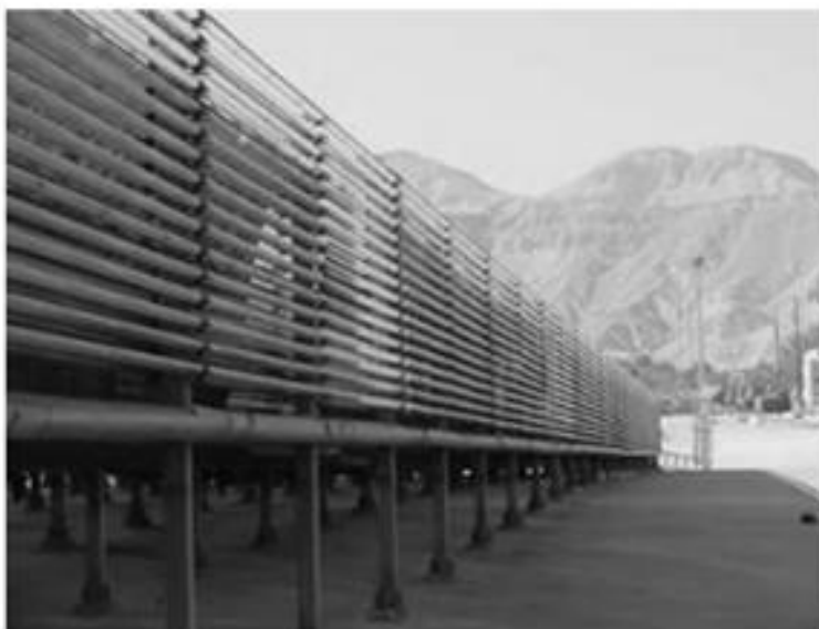
Рисунок 1.4 – Открытая циркуляционная установка по выращиванию хлореллы
