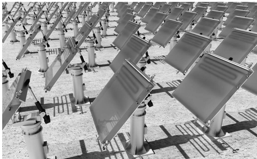
Рисунок 1.5 – Адаптируемая к направлению излучения установка для выращивания хлореллы
