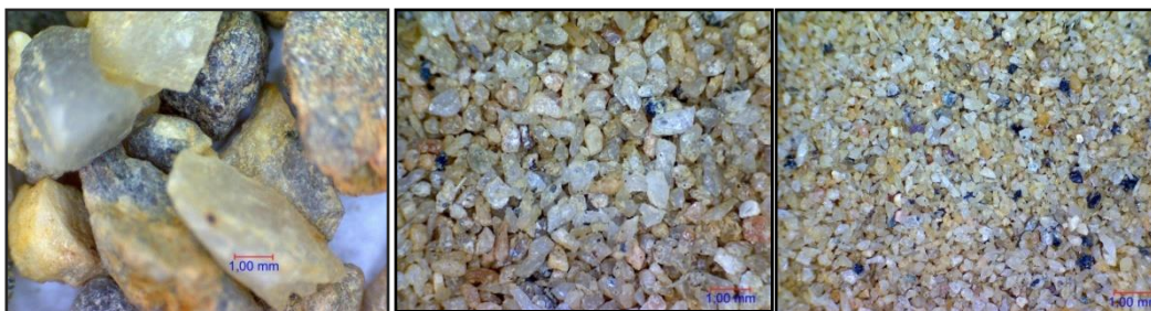
Рисунок 8 - Микрофотографии хвостов обогащения фракций > 2 мм (а), 0,5+0,315 мм (б), < 0,25 мм (в)
