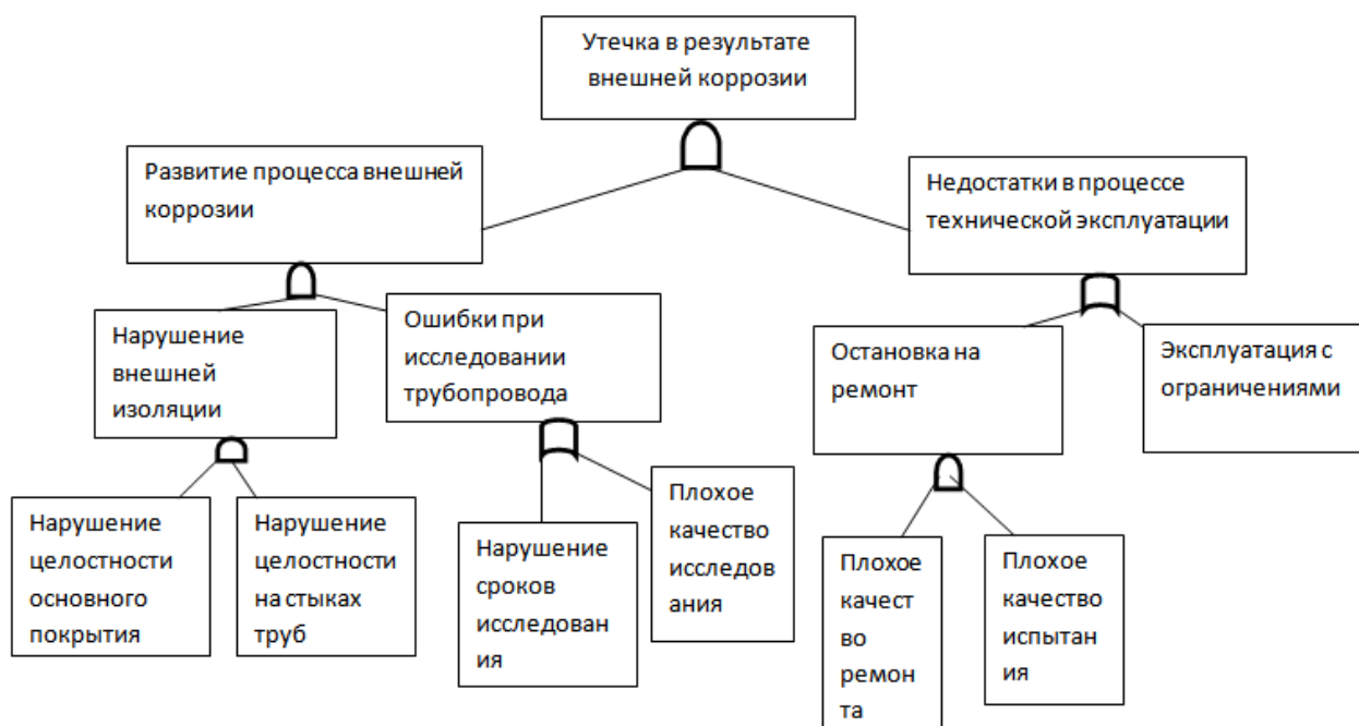
Рисунок 3 – Дерево отказов для аварии, связанной с внешней коррозией трубопровода
