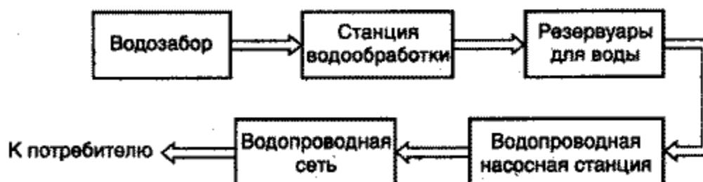
Рисунок 1.5.1 Схема водоснабжения (водопровод) [13]
