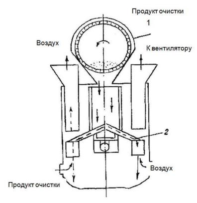
Рисунок 1 — Схема очистки гранулированного полиэтилена с помощью грохота.
