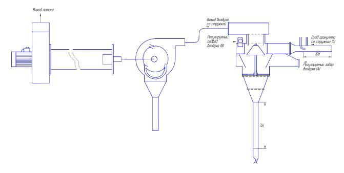
Рисунок 15 – Схема экспериментального стенда комплексной очистки
