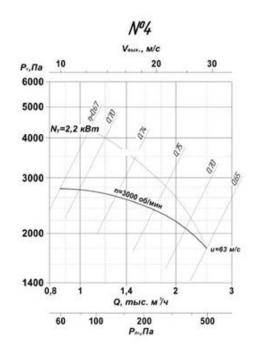
Рисунок 14 – Аэродинамические характеристики насоса ВЦ 5-35 №4
