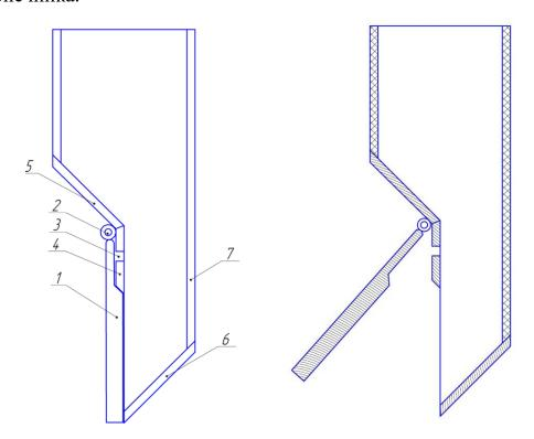
Рисунок 4 — Устройство для повышения стабилизации выгрузки материала (затвор непрерывной выгрузки).
