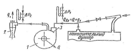
Рисунок 7 — Способ сепарации из воздушного потока наэлектризованной полимерной примеси
