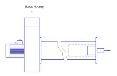
Рисунок 13 – Схема фильтра и вентилятора
