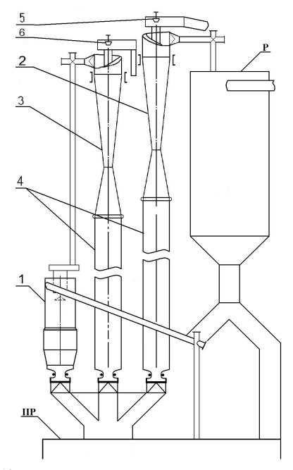
Рисунок 10 — Система пылеотделения установки пневмотранспорта цемента
