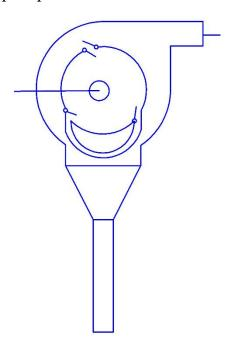
Рисунок 12 – Схема вихревой камеры
