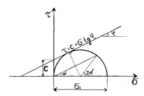
Рисунок 9 — Связь между главным напряжением и касательным напряжением на круге Мора (зависимость напряжения от угла наклона площадки в сыпучем материале)
