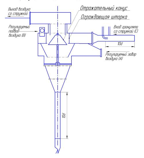
Рисунок 11 – Схема центробежного сепаратора
