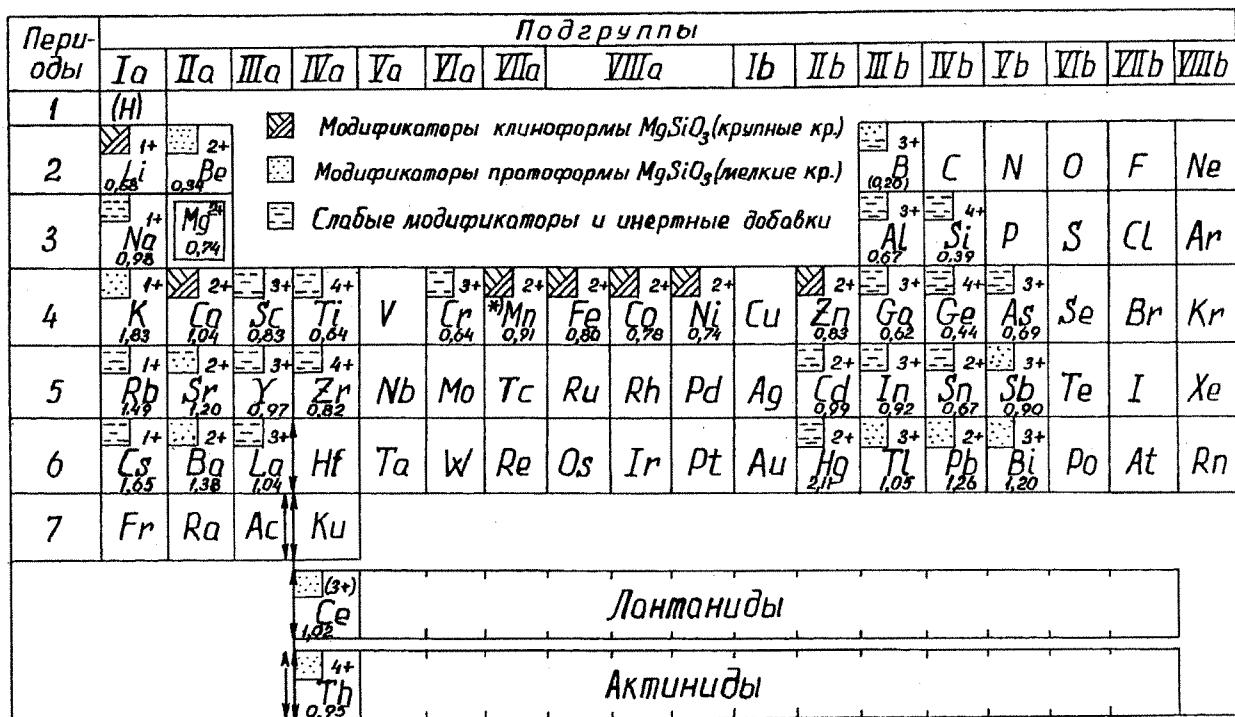
Рис. 2. Расположение модификаторов крупнокристаллического клиноэнстатаита ( $\text{MgSiO}_3$ ) и мелкокристаллического протоэнстатаита ( $\text{MgSiO}_3$ ) в периодической системе элементов по экспериментальным данным
