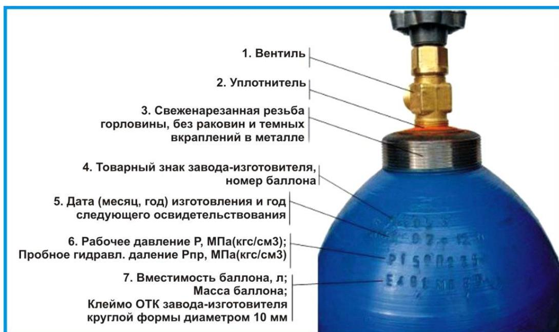
Рисунок 6 – Верхняя часть газового баллона
