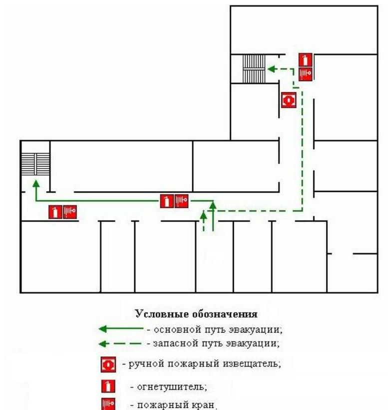
Рисунок 21 – План эвакуации на этаже
