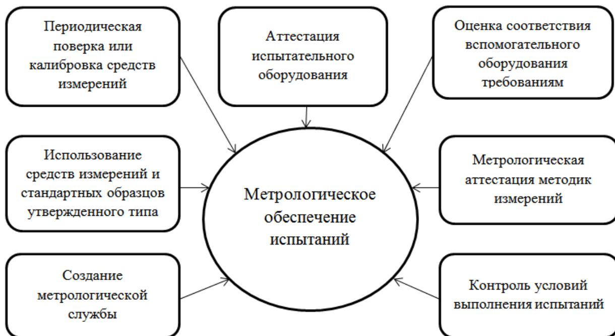
Рисунок 1 – Основные требования к метрологическому обеспечению испытаний
