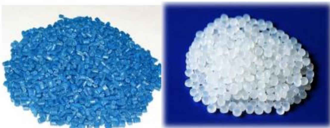
Рисунок 2 – Окрашенный и неокрашенный полипропилен в виде гранул
