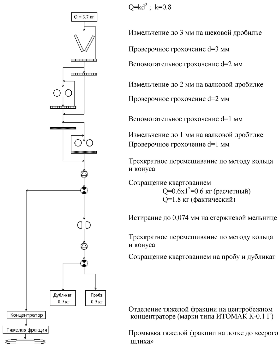
Рис.4.2. Схема обработки керновых и задириковых проб
