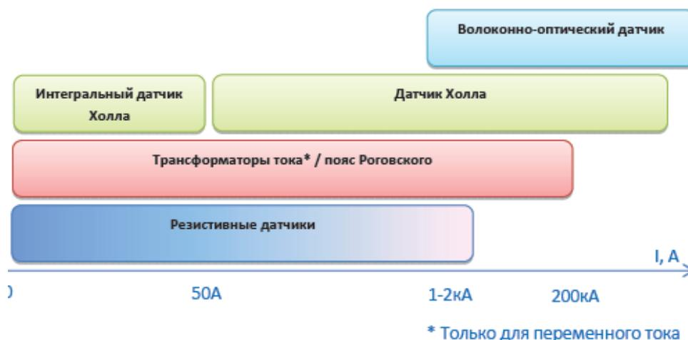
Рисунок 9 - Области применений различных токовых датчиков для переменного тока
