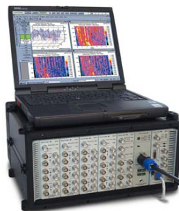
Рис. 3. Модульная многоканальная система анализа PULSE типа 3560-D
