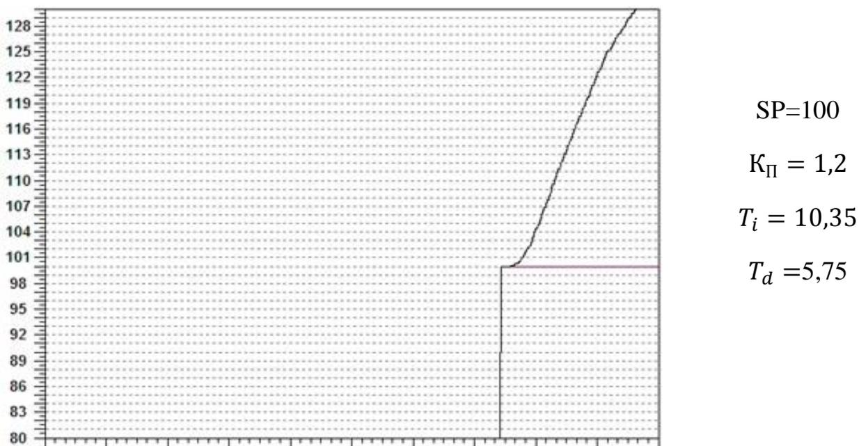
Рисунок 3.2.3 - Переходный процесс в системе с ПИД-регулятором
