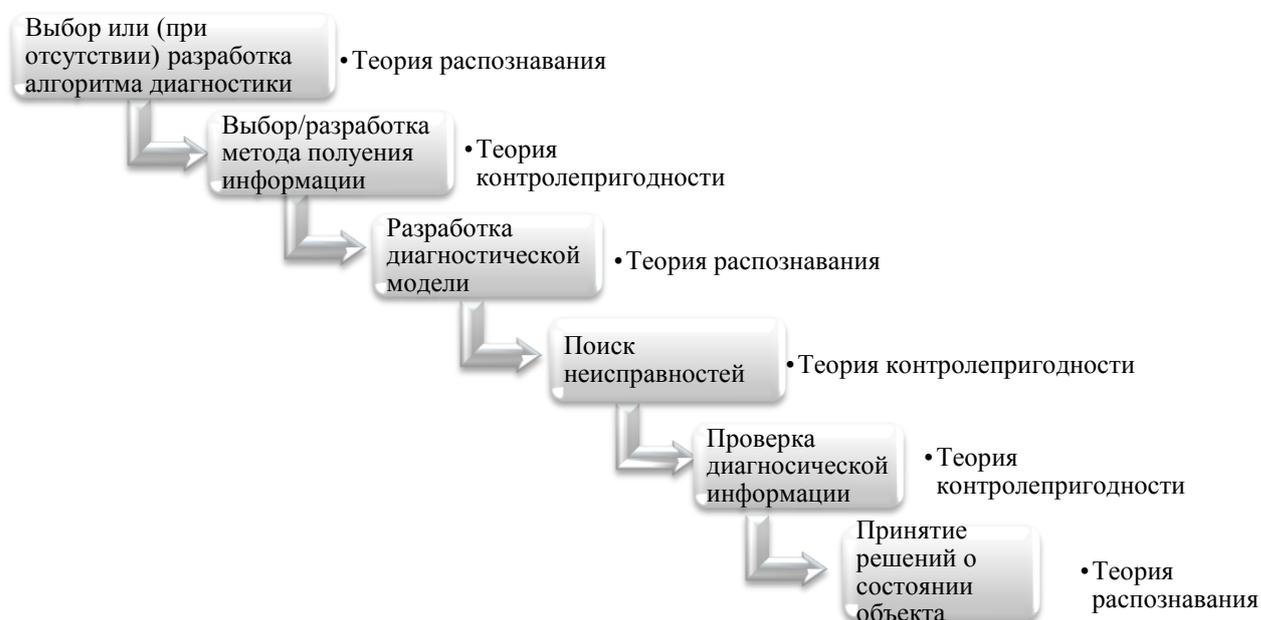
**Рисунок 2** – Алгоритм проведения оценки работоспособности
