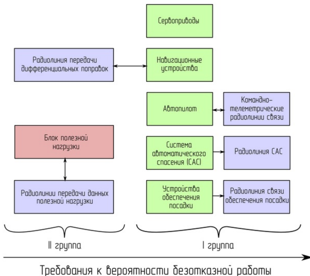
Рисунок 12 – Упрощенная классификация оборудования БЛА по требованиям к вероятности безотказной работы.
