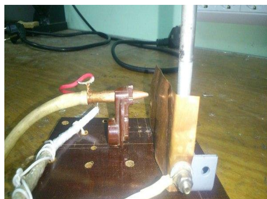
Рисунок 27 - Фотографии реализованного макета тест-объекта. Справа – силовая часть. Слева - конструкция подвижного электрода.
