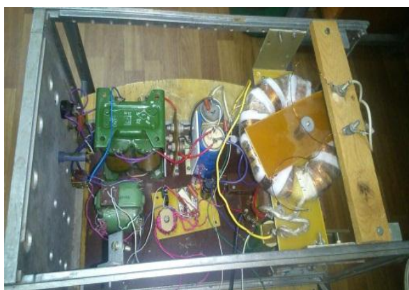
Рисунок 27 - Фотографии реализованного макета тест-объекта. Справа – силовая часть. Слева - конструкция подвижного электрода.
