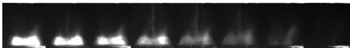
Рисунок 9 - Временное развитие лазерного факела демонстрирующее образование частиц. Релеевское рассеяние.
