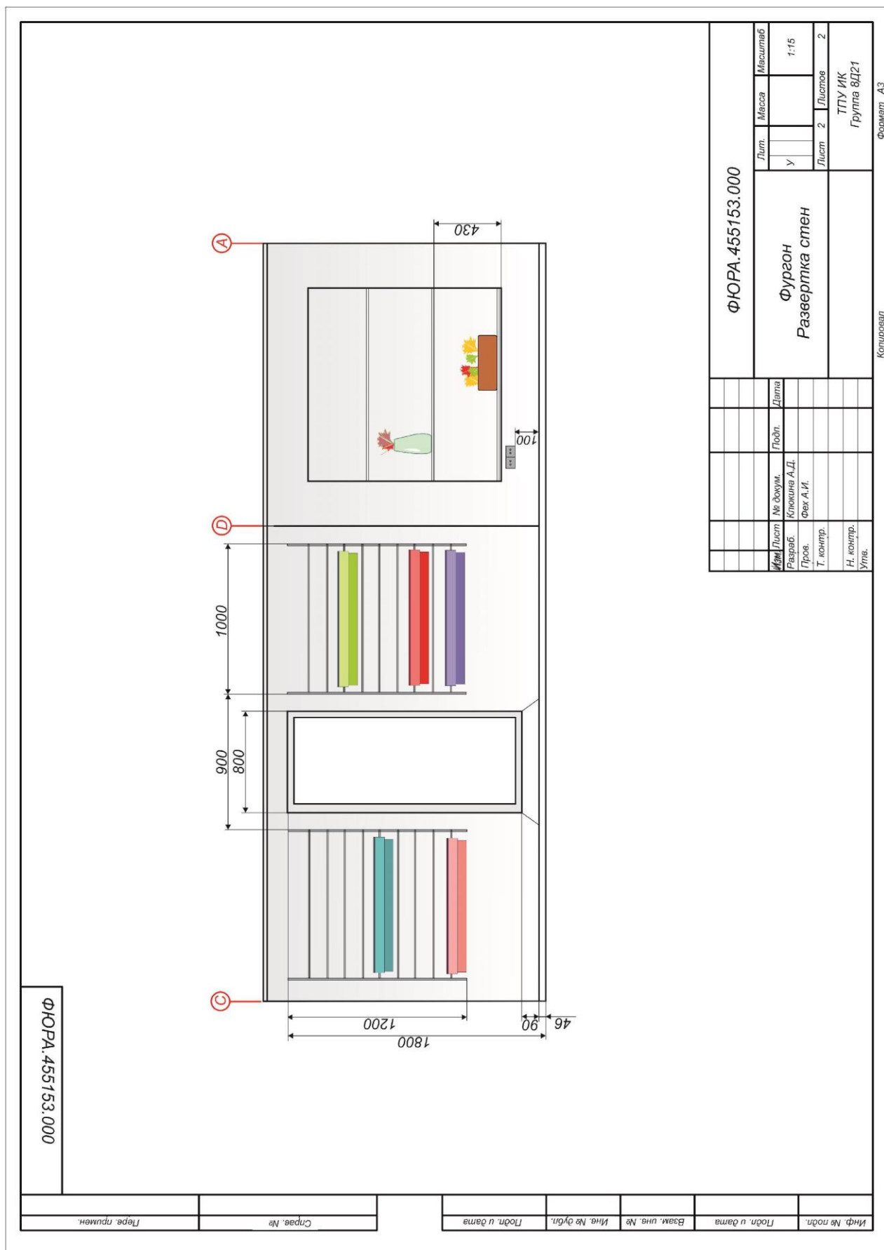
Рисунок Г.2 – Развертка стен фургона-прицепа
