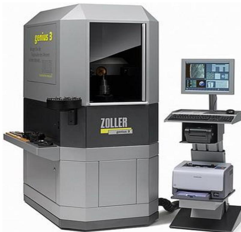
Рисунок 9 - Координатно-измерительная машина мод. Genius 3 фирмы Zoller
