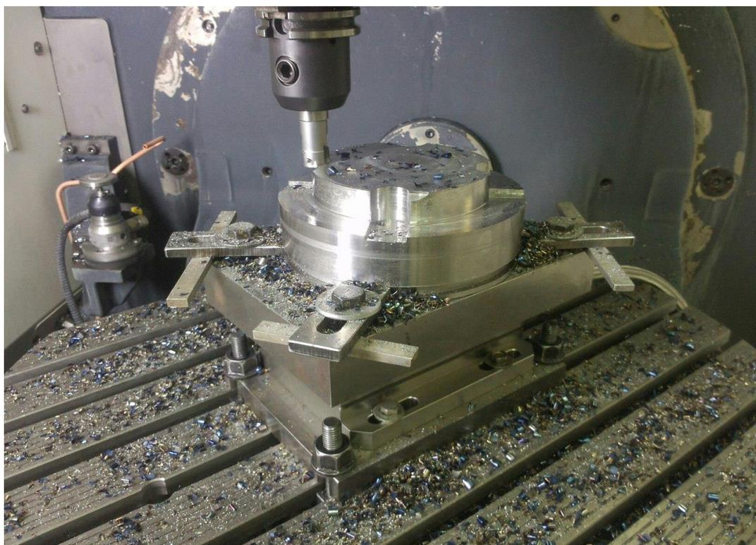
Рисунок 15 - Вид установки для измерения составляющих силы резания динамометром фирмы *Kistler* (Швейцария)
