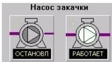
Рис. 14. Мнемознак «Насосного оборудования».
