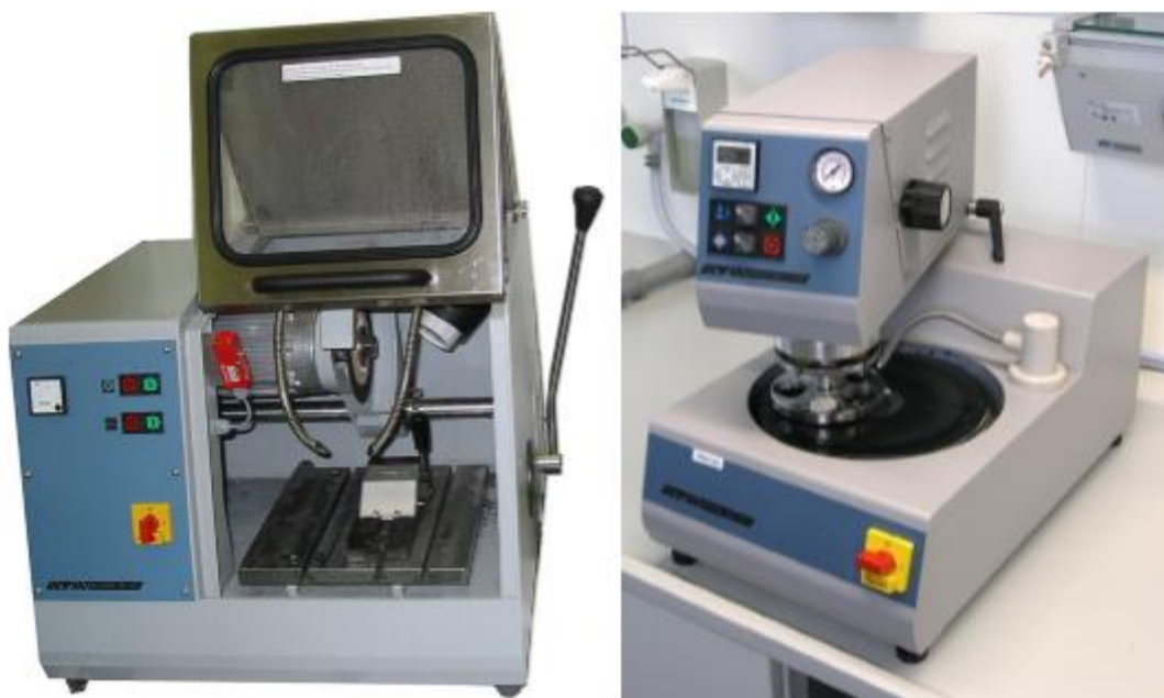
Рисунок 2.16 – Оборудование ЦИСМ для подготовки экспериментальных образцов: а) Отрезной станок ATA BRILLANT 201, б) Шлифовально-полировальная машина ATA SAPHIR 320
