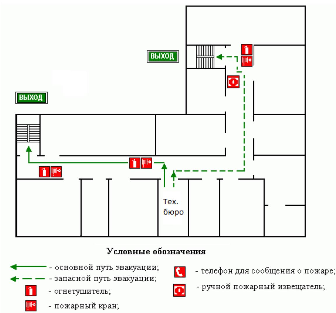
Рисунок 19 – План эвакуации из технологического бюро
