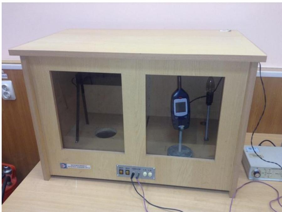
Рисунок 14 – Общий вид стенда «Звукоизоляция и звукопоглощение – БЖ 2м»
