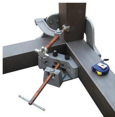
Рисунок 44 –Установка угловой струбцины
