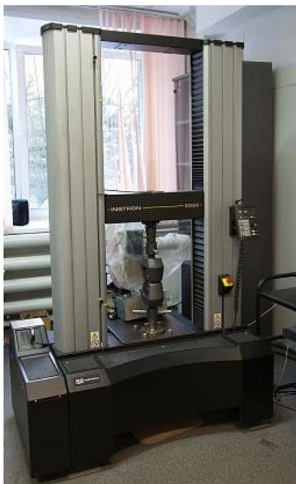
Рисунок 7 – Электромеханическая испытательная машина Instron 5582
