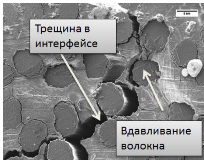
Рисунок 5.13 - РЭМ изображение поверхности композита после вдавливания индентера Берковича
