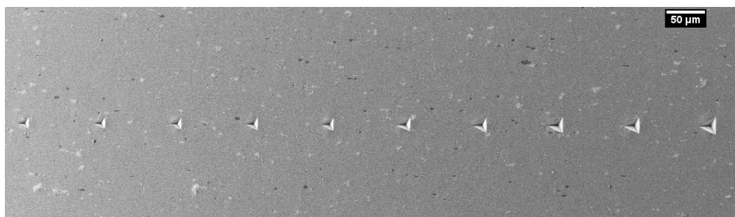
Рисунок 4.8 - РЭМ изображение 10 одиночных углублений, полученных в инструменте Hysitron TI 950
