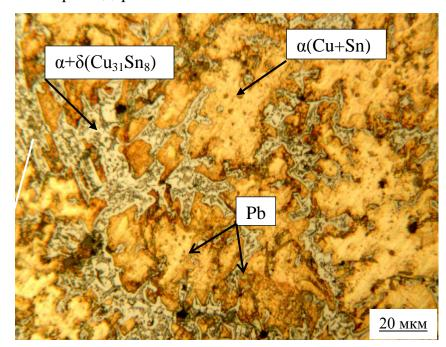
Рисунок 7 – Микроструктура БрС10О15
