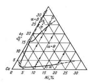
Рисунок 4 – Изотермический разрез (медный угол) диаграммы состояния сплава Cu-Sn-Ni при 20°C
