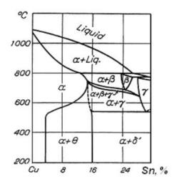
Рисунок 3 – Политермический разрез диаграммы состояния сплавы Cu-Sn-Ni содержащего 2% Ni
