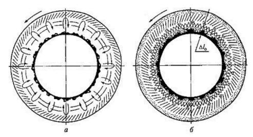
Рисунок 6 — Схема возникновения конвективных потоков (показаны фигурными стрелками) во вращающемся затвердевающем расплаве (а) и схема кристаллического строения отливки (б):  $l_0$  — глубина расположения усадочной пористости; стрелкой показано направление вращения изложницы
