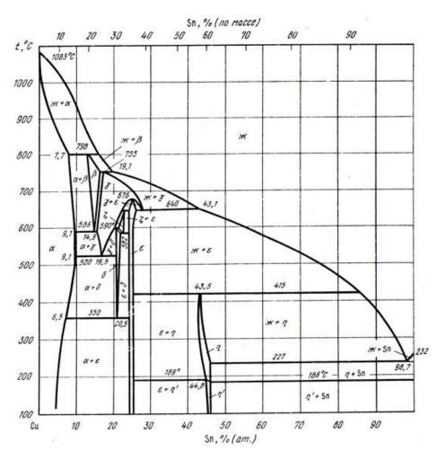
Рисунок 1 - Диаграмма состояния системы Cu - Sn
