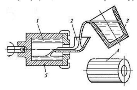
Рисунок 5 — Схема получения отливки при вращении формы вокруг горизонтальной оси: 1 — расплав; 2 — заливочный желоб; 3 — ковш; 4 — отливка; 5 — форма
