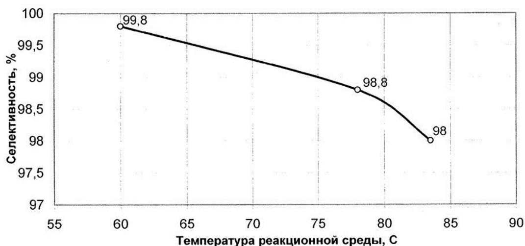
Рисунок 4 – Зависимость селективности процесса от температуры реакционной среды
