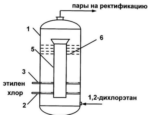
Рисунок 2 – Реактор высокотемпературного хлорирования
