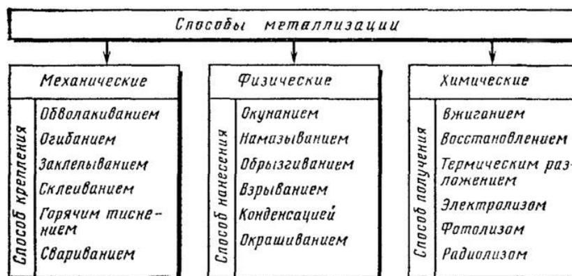
Рисунок 1.5 -Классификация способов металлизации
