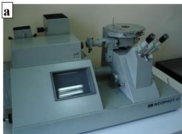
Рисунок 4 – Металлографический микроскоп Neophot-21 (а), сканирующий интерференционный микроскоп New View 6200 (б)
