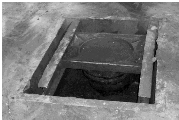
Рисунок 1.3 – Наканавный гидравлический подъемник.
