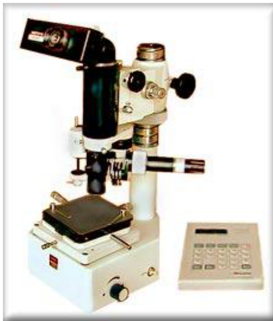
Рисунок 9 – Общий вид прибора ПМТ-3М для определения микротвердости
