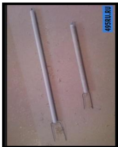
Рис. 14 а) термопара хромель-копель ДТПШ 014-00.20/3, б) датчик 2TRM1
