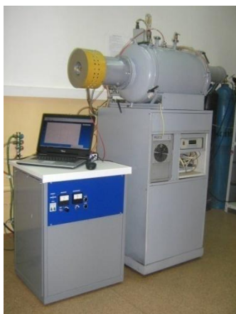
Рис. 10 Общий вид установки ионно-плазменного модифицирования поверхности и напыления покрытий.
