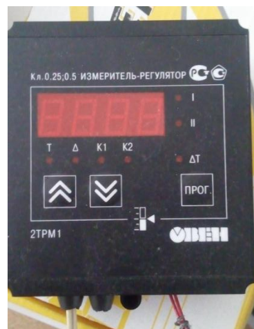
Рис. 14 а) термопара хромель-копель ДТПШ 014-00.20/3, б) датчик 2TRM1
