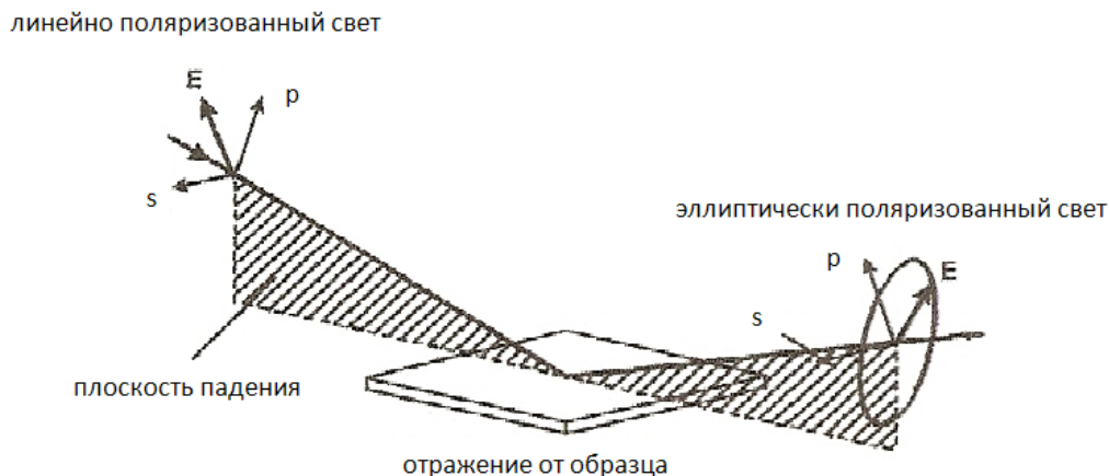
Рис. 8 Схема взаимодействия поляризованного света с образцом.
