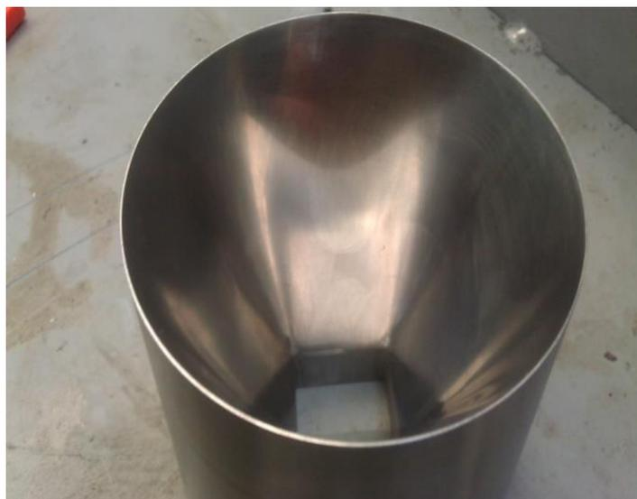
Рисунок 2.8. Деталь после доводочной операции
