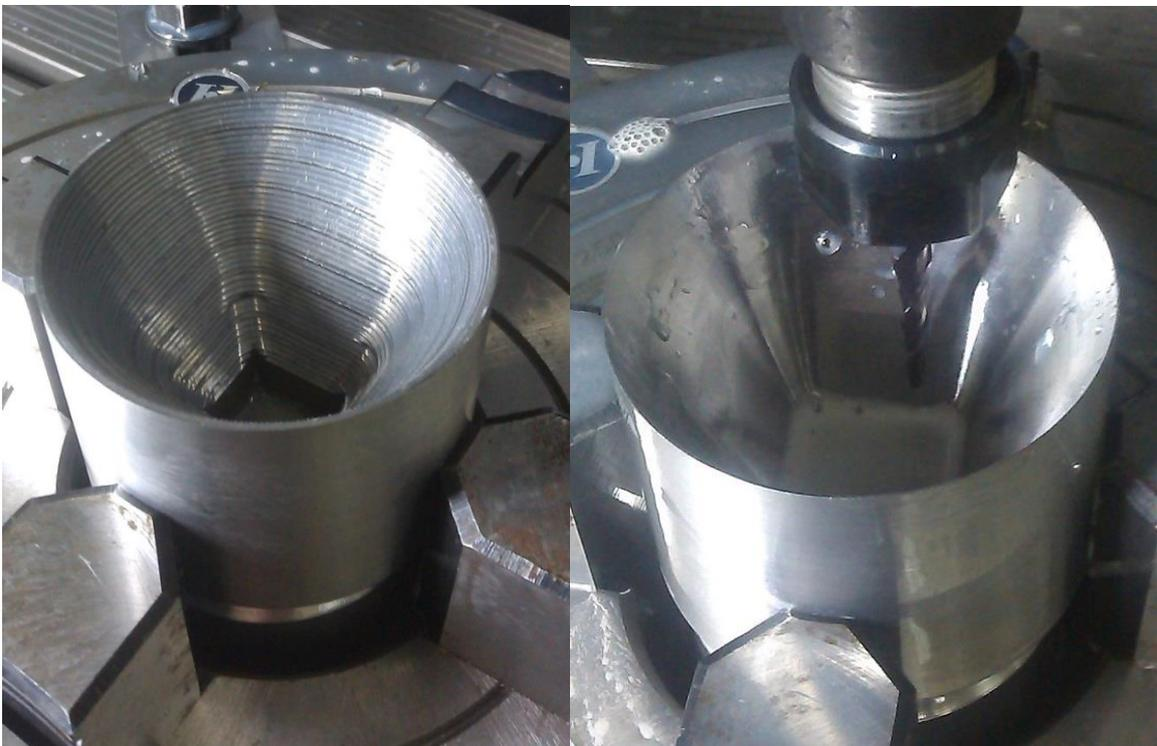
Рисунок 2.7. Заготовка после чернового (слева) и чистового фрезерования (справа)
