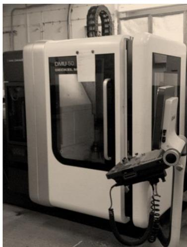
Рисунок 2.1. Станок с ЧПУ “DMU – 50”
