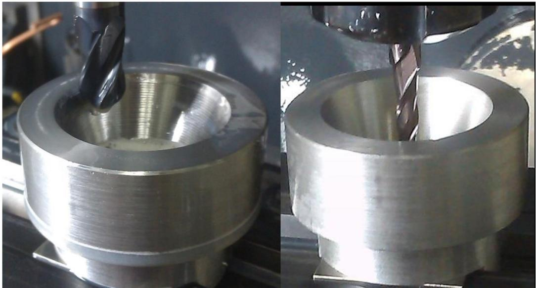
Рисунок 2.5. Чистовое фрезерование заготовки радиусной фрезой (слева) и конической фрезой (справа).
