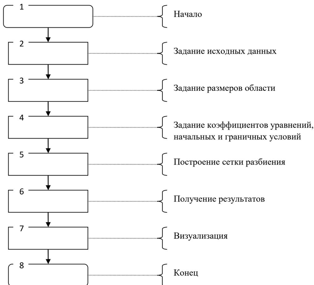
Рисунок 2 – Блок-схема алгоритма моделирования расчетной области бетатрона
