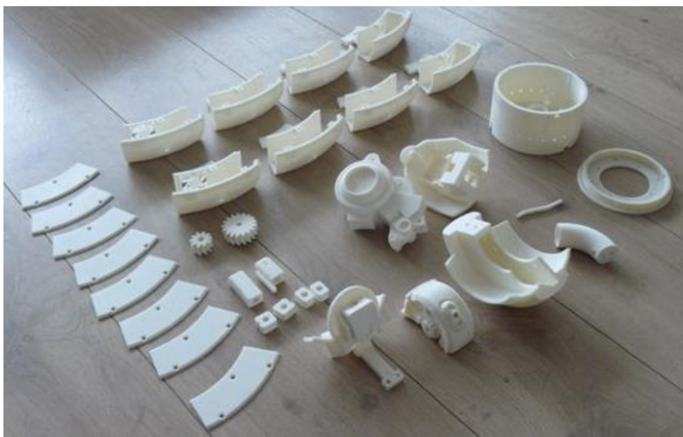
Рисунок 2. Напечатанные детали манипулятора.
