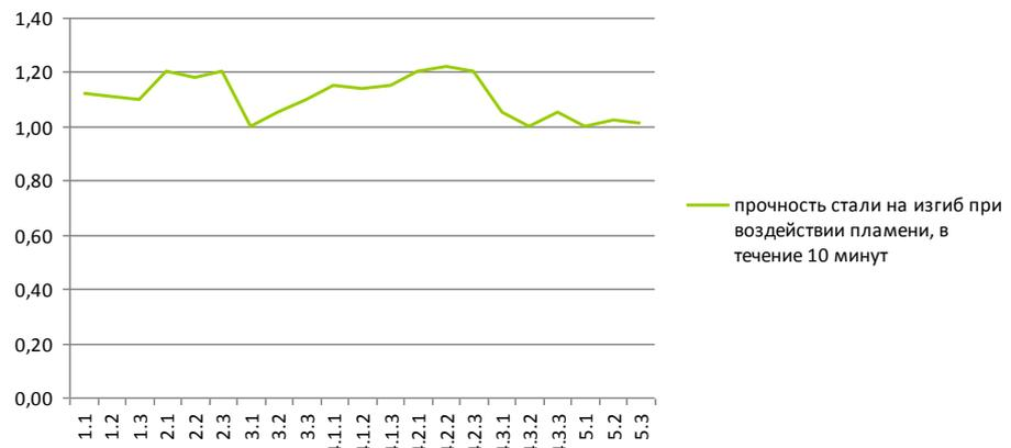
Рисунок 10 – Прочность стали на изгиб, при воздействии пламени, в течение 10 минут
