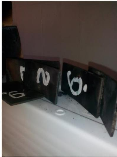
Рисунок 13 – Металлические пластины в образцах, подвергшихся воздействию открытого пламени, после испытания на прочность стали на изгиб
