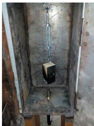
Рисунок 7 – Расположение образца в приборе для определения огнестойкости модификации ОТ – 68 (ГОСТ 15898-70)
