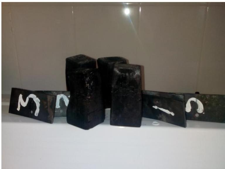
Рисунок 12 – Результаты воздействия открытого пламени в течение 10 и 25 минут на пробы образца №5 необработанного огнезащитными средствами
