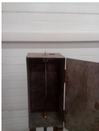
Рисунок 6 – Прибор для определения огнестойкости модификации ОТ – 68 (ГОСТ 15898-70)
