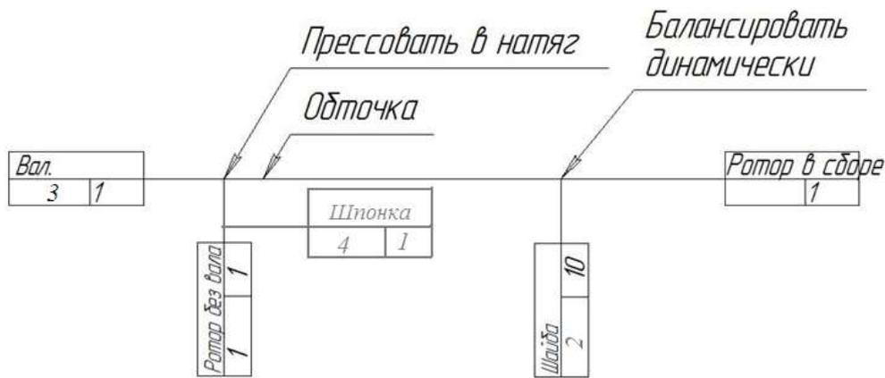
Рисунок 13 – Схема сборки
