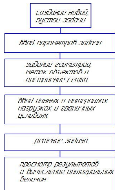
Рис.4.2- Блок-схема алгоритма решения задачи в программе ELCUT
