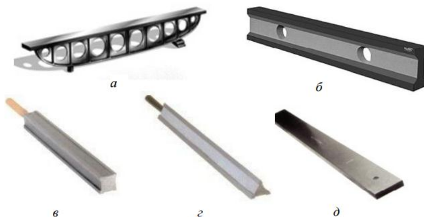
Рисунок 2.1- Примеры конструктивного исполнения поверочных линейек: а - в виде мостика, б - в виде двутаврового сечения, в – четырехгранные, г – трехгранные, д – прямоугольные [11]
