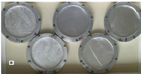
Рисунок 6 – Контейнеры для облучения образцов полимерной пленки ионами гелия
