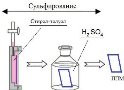
Рисунок 11 – Схематичное представление процесса сульфирования
