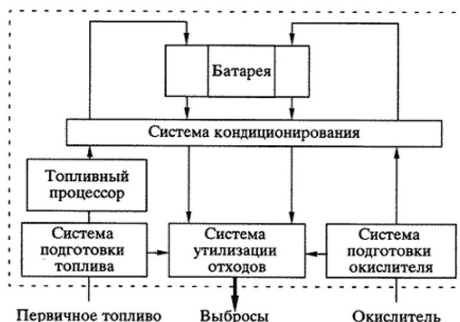
Рисунок 2 –Схема электрохимического генератора.
