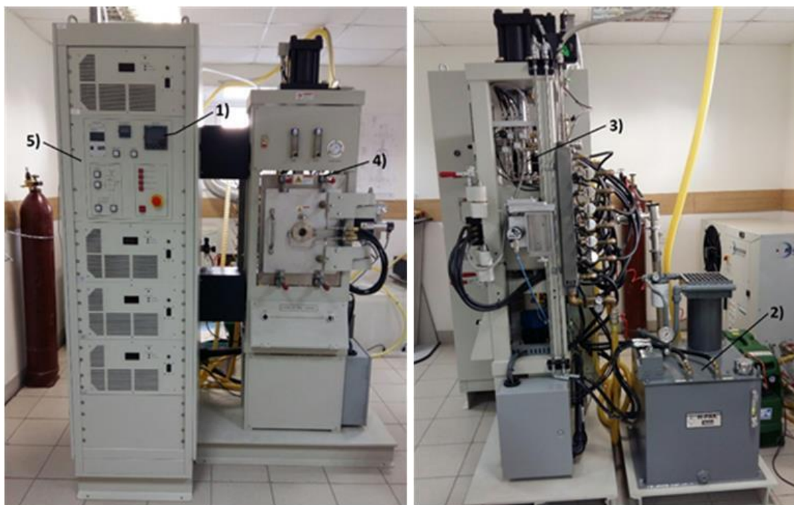
Рисунок 2.8 Установка по спеканию порошковых материалов SPS-10-4
