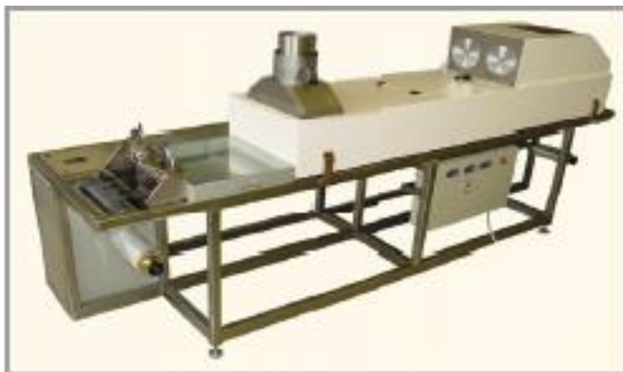
Рисунок 1.2 Установка литья подложек на плёнку фирмы КЕКО (Словения)
